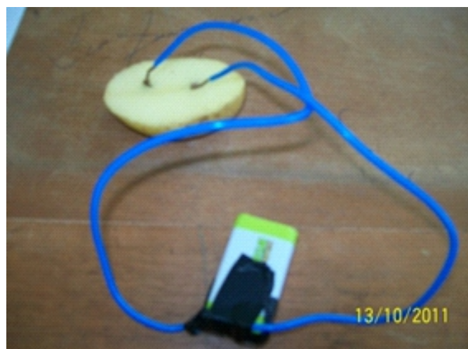
Figura 01: Ilustração do experimento da construção de uma pilha utilizando batata, fios de cobre e bateria de 9V.
