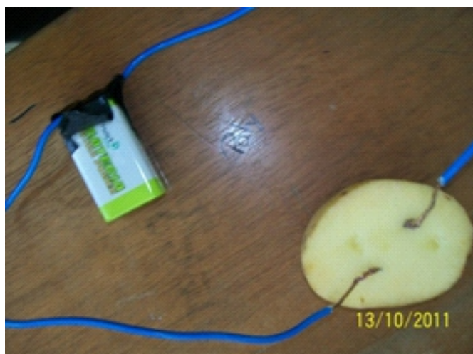
Figura 01: Ilustração do experimento da construção de uma pilha utilizando batata, fios de cobre e bateria de 9V.
