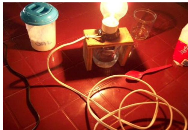
FIGURA 3: Aparato para a observação da condução de corrente elétrica. Foto: Josimara C. C. Oliveira.
