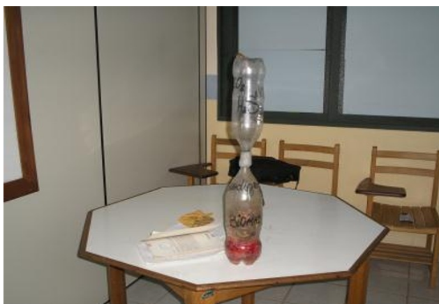
Figura 4: Biodigestor caseiro, construído com garrafas PET. Foto: Josimara C. C. Oliveira.
