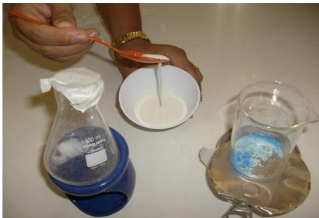
FIGURA 2 – Da esquerda para a direita: Sublimação da naftalina (utilizando suporte de argila e vela como fonte de aquecimento), a formação do sol com amido de milho e água, a desidratação do  $\text{CuSO}_4$  (utilizando uma latinha de molho de tomate usada, vela e lacre de lata de achocolatado para o aquecimento). Foto: Josimara C. C. Oliveira.
