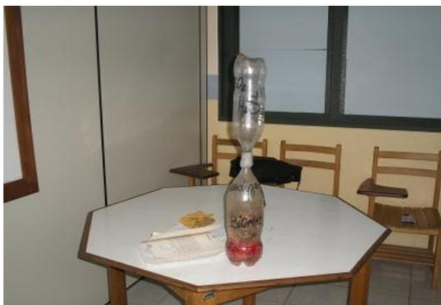
Figura 4: Biodigestor caseiro, construído com garrafas PET.
